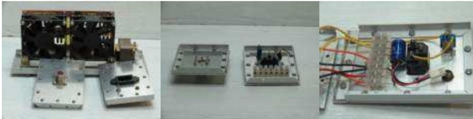
Las figuras número quince y dieciséis nos muestran la carga terminada y preparada para las pruebas preliminares. Para completar el montaje se ha preparado una cubierta de chapa perforada que permite la ventilación de las resistencias y proporciona el adecuado blindaje para la RF. Esta cubierta se fija en los ángulos laterales mediante unos tornillos autorosca. En las figuras número diecisiete y dieciocho tenemos la carga terminada.
