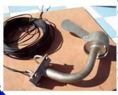
Todos los materiales para construirla son reciclados: el soporte de la paleta es el capuchón plástico de un viejo termo, pintado de aluminio para protegerlo de los ultravioletas; la paleta es un pedazo aluminio de descarte y en el extremo opuesto a ella hay una pequeña lámina de plomo para que el balance sea perfecto. El disco duro roto de un antiguo PC proporcionó los dos pequeños pero potentes imanes que accionan sobre los relays y también el
