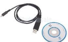
hace del USB un COM 3 para que el "N1MM", o cualquier otro programa, haga cambiar de frecuencia y modo al equipo y viceversa, cambiando frecuencia en el equipo los cambios aparecen en la pantalla del programa.
