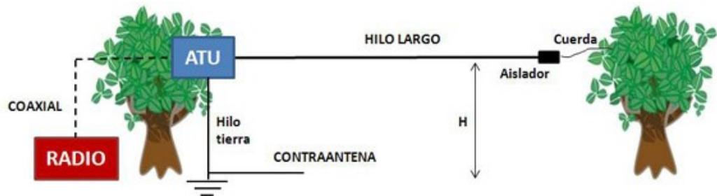
Las antenas de hilo largo, también conocidas como '*long wire*', son probablemente las antenas de HF más baratas y más sencillas de construir. Tan sólo se requiere un hilo conductor, de longitud  $L$ , dispuesto en forma rectilínea y conectado a la radio en uno de sus extremos (mediante un cable coaxial, por ejemplo) y con el otro extremo en circuito abierto, conectado mediante un aislador a un soporte para mantenerlo separado del suelo.
