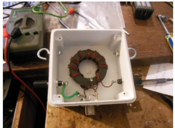
La salida de la derecha de la caja del balun se conecta al hilo largo, la izquierda a Tierra y el conector PL259 al cable coaxial que va al transmisor.
