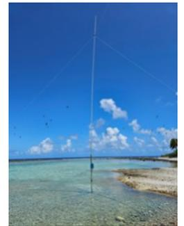
V10: Una antena vertical de 38 pies, alimentada a través de un sintonizador automático que cubre de 80 a 10 m. La antena utiliza agua salada como suelo. Basada en el kit ATK65A de DXengineering.
