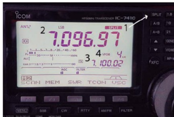
Foto 1: 1. Botón de control e indicación de función Split activa en display. 2. Frecuencia del receptor (OFV A). 3. Frecuencia del transmisor. 4. Indicador del OFV transmisor, en este caso el B.
