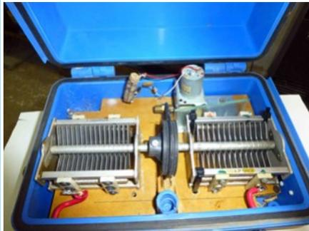
La antena se excita mediante un lazo de un quinto del perímetro (1,96 m para un cuadro de 9,8 m totales), fabricado con cable RG-213 en configuración aperiódica. Su rendimiento fue notable, estimado superior al 60%, con contactos DX y locales exitosos. Eso sí, su polarización vertical y direccionalidad pueden limitar la cobertura en QSOs cercanos.
