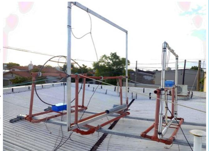
El mayor desafío fue el condensador variable para sintonizar la antena en 80 metros. Este condensador no es crítico por su capacidad, sino por su aislación, ya que pensaba trabajar con 300 W en BLU y modos digitales. Construí varios caseros, cortando chapas a tijera y armándolos como podía... pero siempre terminaban en fuegos artificiales. Además, necesitaba un condensador de 260 pF, lo que, al trabajar con espaciados grandes (más de un centímetro), lo volvía muy voluminoso.
