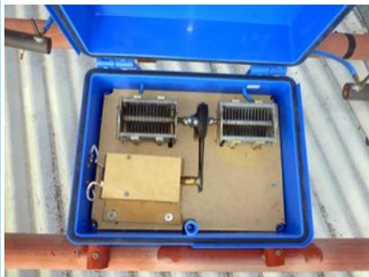
La antena tiene un perímetro de 4 metros, y para reducir la tensión que deben soportar los condensadores, añadí dos "colitas" de aproximadamente 50 cm cada una, que quedan fuera del rango de acción del variable. Esto
