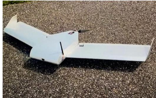
Diseñada en espuma para soportar las bajas temperaturas de la estratósfera, el ala integra una controladora de vuelo y un microprocesador que activan la maniobra de regreso al llegar a la altitud programada. El aterrizaje se realiza con un patrón en espiral para evitar obstáculos como árboles y facilitar la recuperación intacta del equipo.
