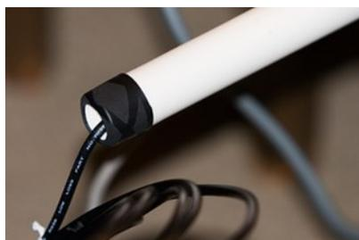
El tipo de cable coaxial es importante. Utiliza solo cable coaxial de malla trenzada. No uses cable coaxial con un apantallado de lámina, ya que la lámina tiende a romperse durante el montaje, especialmente en las curvas pronunciadas en los puntos de entrada/salida de la bobina de choque. Obviamente, si esto sucede, tu antena no funcionará.
