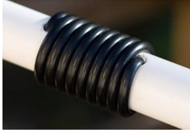
En la parte superior, haz un pequeño (delgado, estrecho) corte en el borde del tubo, tira del hilo de nailon y sujétalo en la muesca. Más tarde, cuando se coloque una tapa, la tapa sujetará firmemente el hilo de nailon en su lugar y mantendrá recto el radiador.
