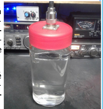
Fig_1: Recipiente de vidrio de 65mm de diámetro x 150mm alto (500 cm 3 ) apto para soportar hasta 300W por 1 minuto (electrodos de Cobre).
